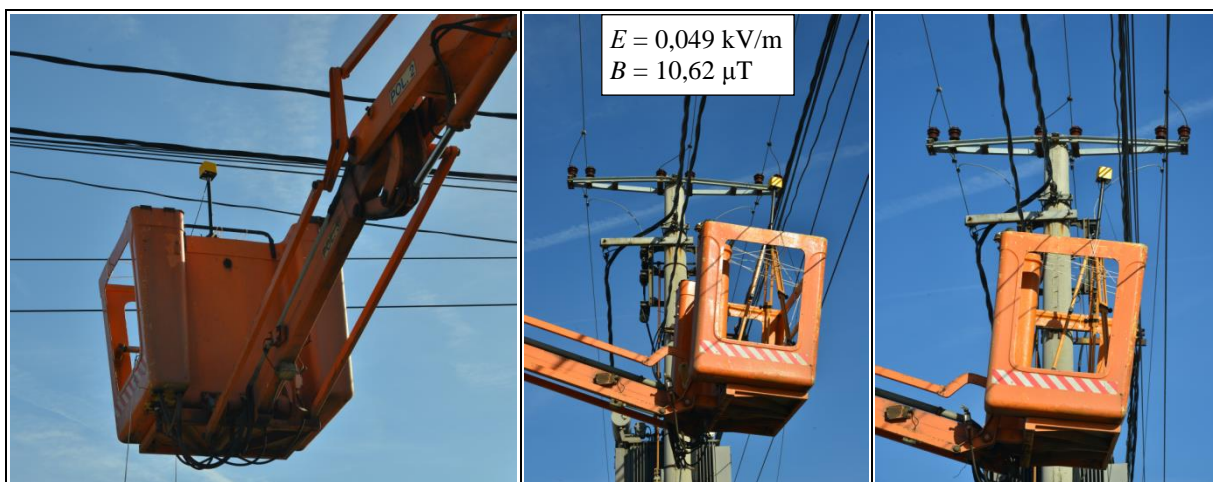
СЛИКА 10 – ПОЗИЦИЈА МЕРНОГ МЕСТА (ИСПОД ДАЉЕГ 0,4 KV СКС-А) И РЕЗУЛТАТИ МЕРЕЊА ( H = 5,9 \text{ M} ; H_K = 4,2 \text{ M} ; H_S = 1,7 \text{ M} )
