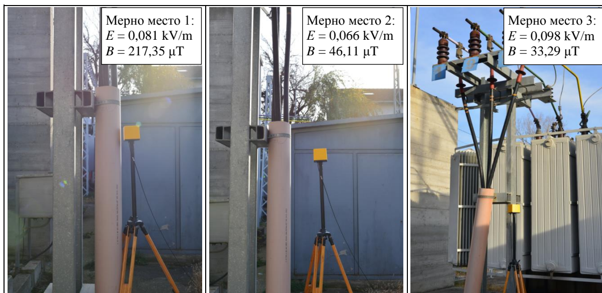
СЛИКА 13 – ПОЗИЦИЈЕ МЕРНИХ МЕСТА 1, 2 И 3 И РЕЗУЛТАТИ МЕРЕЊА ( I = 221 \text{ А} ; H = 1,7 \text{ М} )
